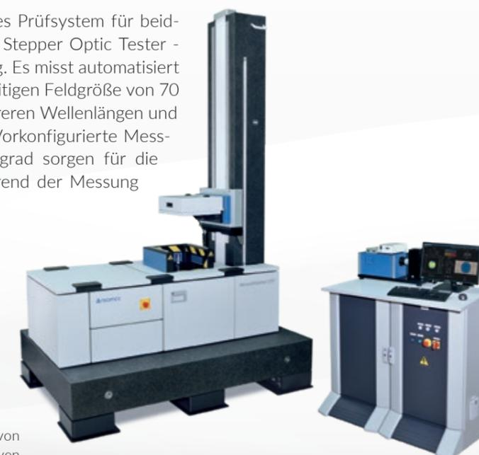
WaveMaster® UST zur Prüfung von beidseitig telezentrischen Objektiven
