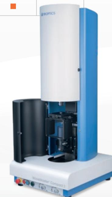
WaveMaster® Compact 2 für die Messung von sphärischen und asphärischen Linsen und Linsensystemen in Transmission und/oder Reflexion
