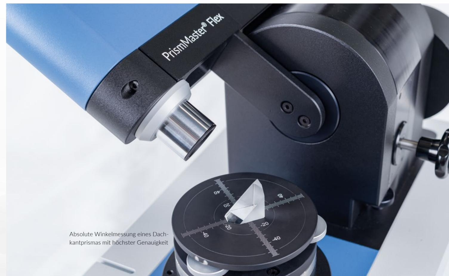
Absolute Winkelmessung eines Dachkantprismas mit höchster Genauigkeit
